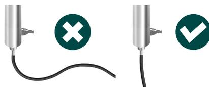
A mangueira de saída de água "E" não pode ser colocada horizontalmente, para que não se acumule água nela
